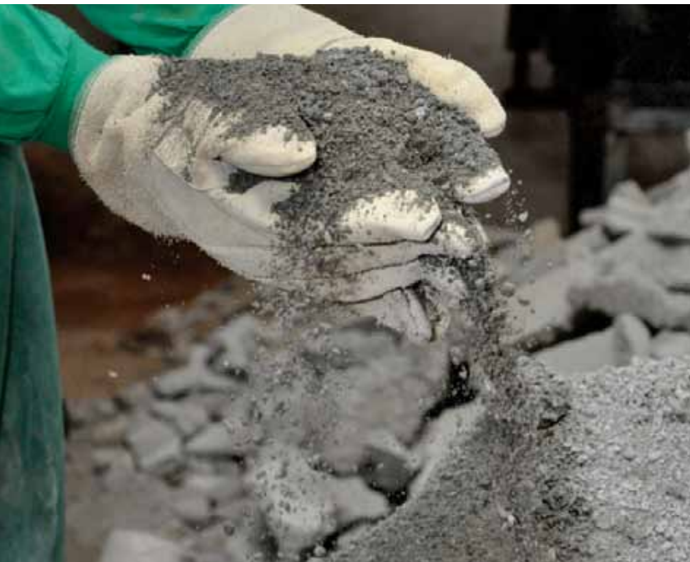
Pontal Engenharia elimina a caçamba de entulho de seus canteiros de obras, com a reciclagem dos resíduos da construção, que retornam ao processo industrial na forma de matéria-prima
