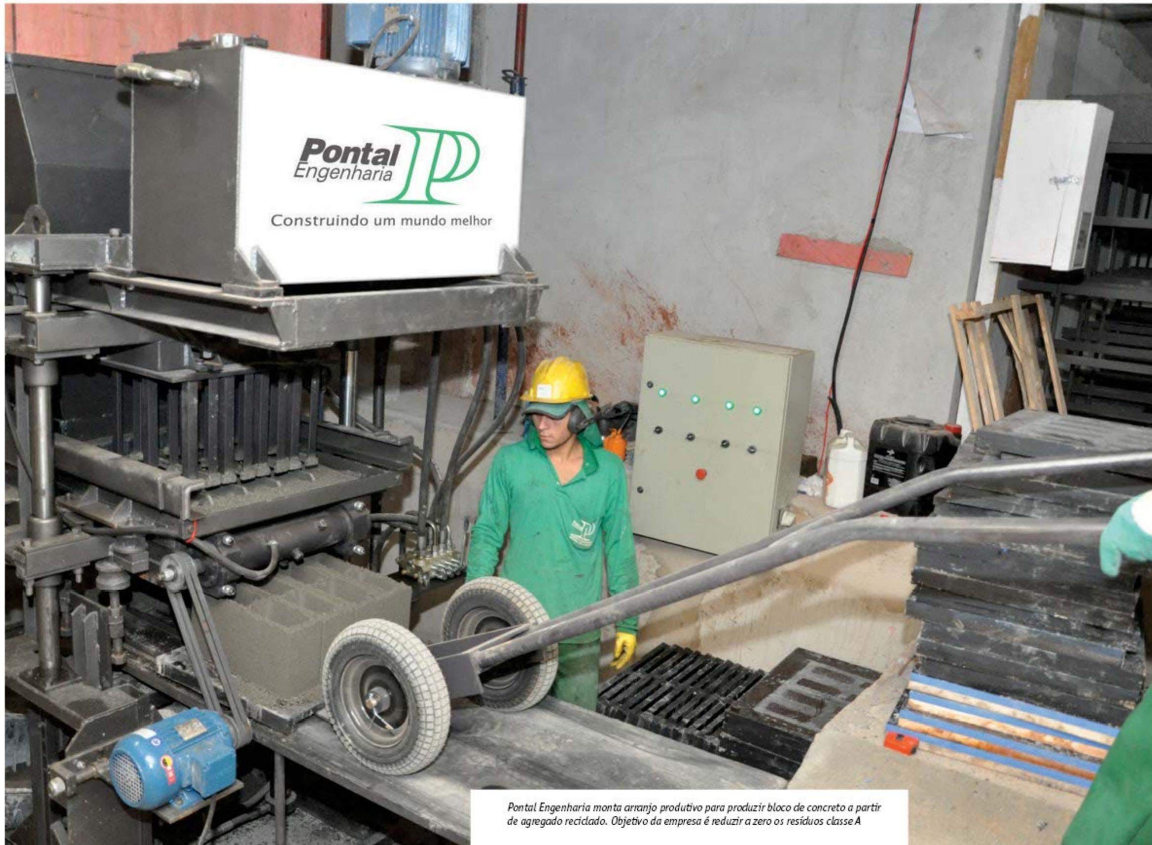
*Pontal Engenharia monta arranjo produtivo para produzir bloco de concreto a partir de agregado reciclado. Objetivo da empresa é reduzir a zero os resíduos classe A*
